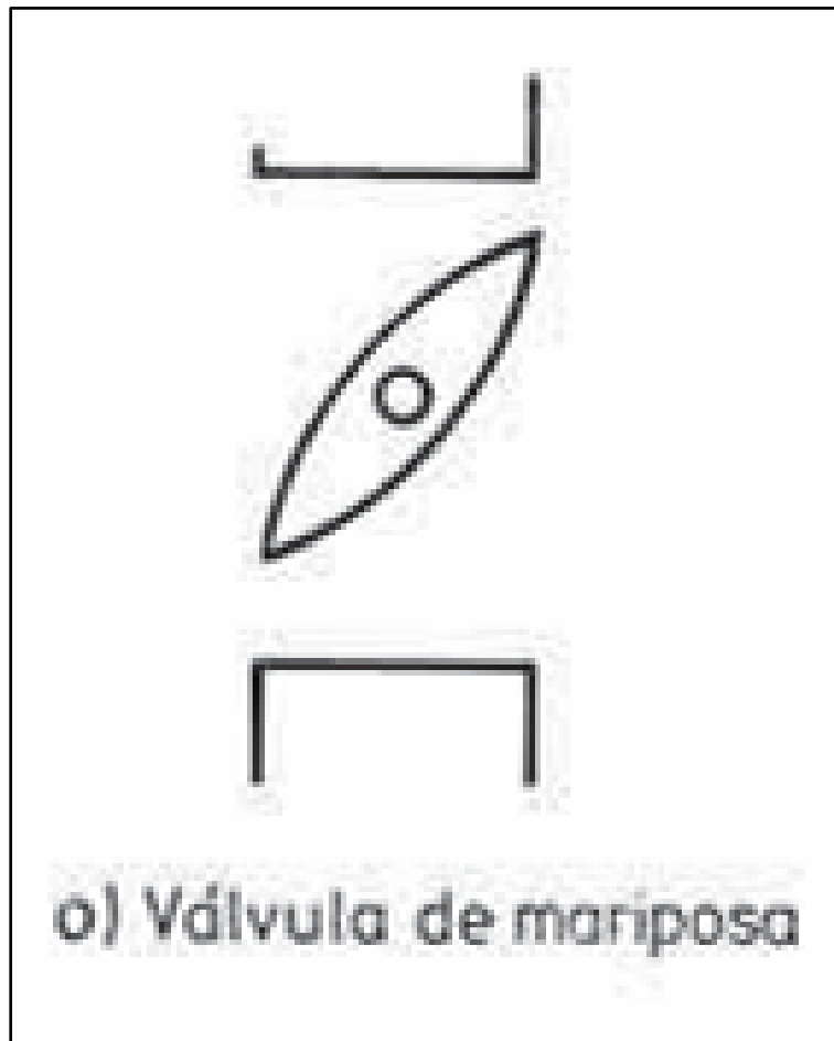
Fig. 31. Representación esquemática de una válvula tipo mariposa [Fuente: Libro Instrumentación Industrial de Antonio Creus].
