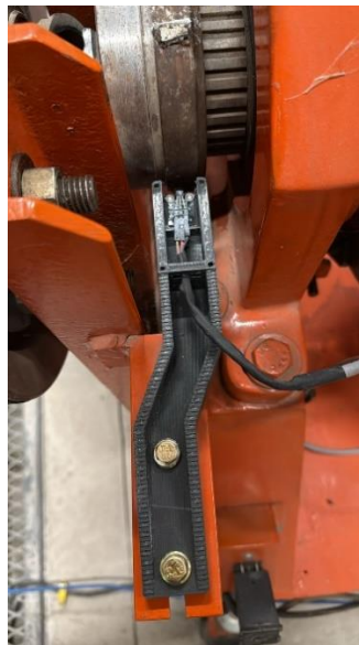
Figura 55. Soporte de RPM instalado.
