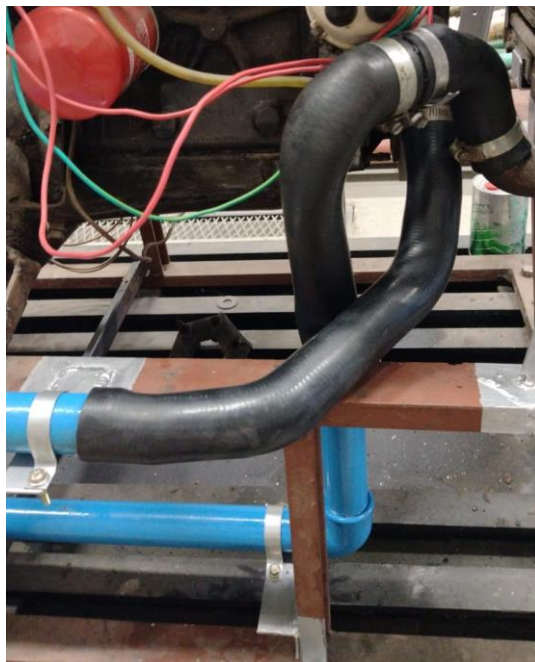
Figura 18. Acople entre el radiador y entrada del frenómetro y entre salida del frenómetro y entrada del motor.
