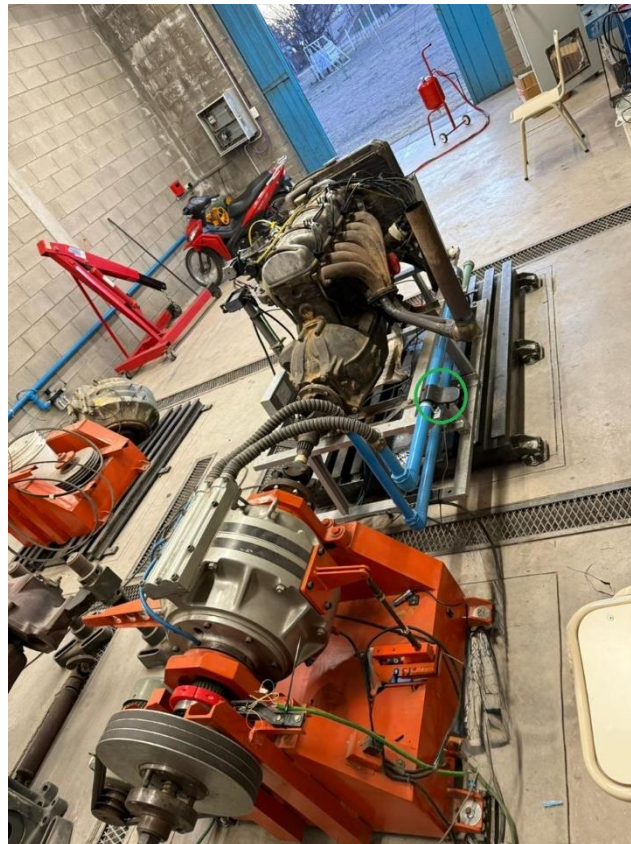
Figura 26. Ubicación termocupla temperatura de freno.
