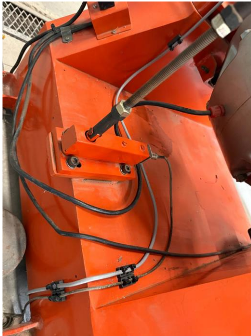
Figura 44. Cables del medidor de RPM y celda de carga fijados al frenómetro.
