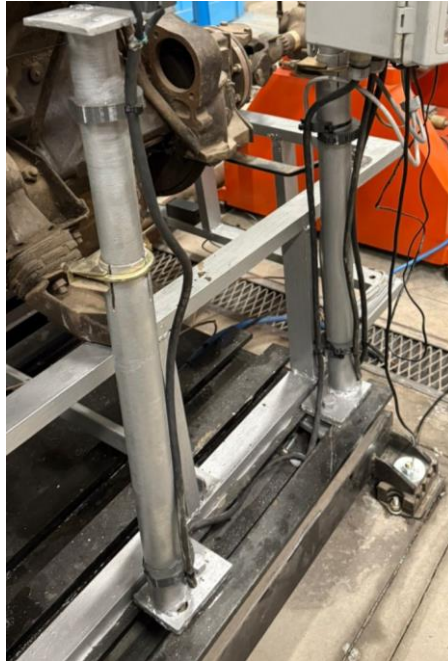
Figura 48. Distribución y organización del cableado restante correspondiente a sensores, actuadores y alimentación de potencia.
