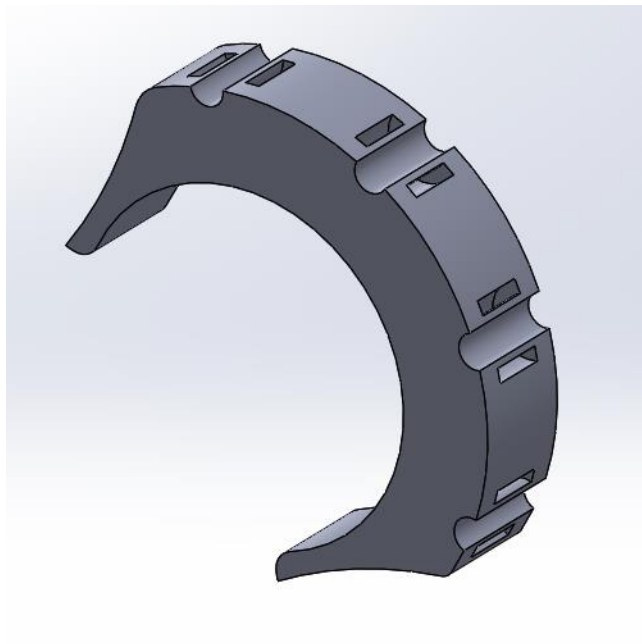
Figura 43. Guía cable para superficie circular tetra canal.
