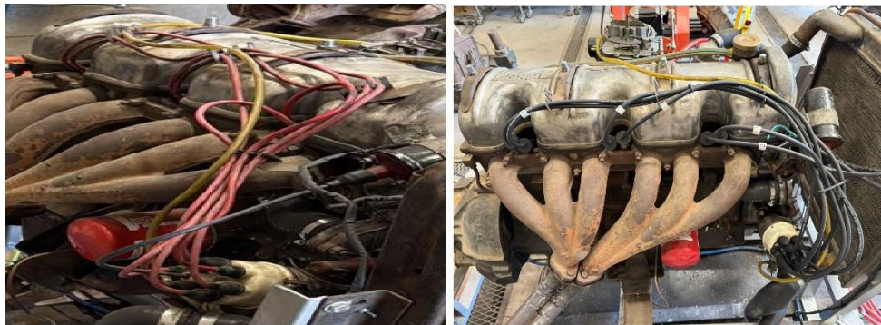
Figura 71. Antiguo cableado de bujía / Nuevo cableado de bujía.
