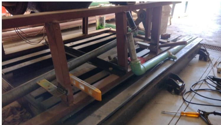
Figura 15. Perfiles angulares soldados.
