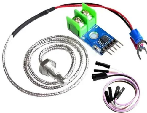
Figura 24. Módulo MAX6675 y termocupla tipo K seleccionada.
