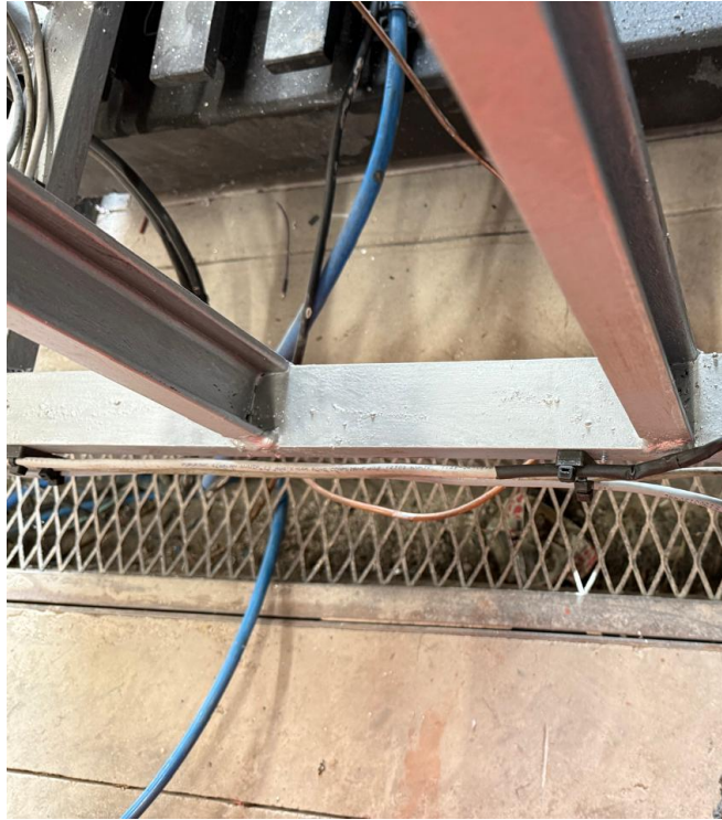
Figura 46. Cables del medidor de RPM, celda de carga y MAX6675 de temperatura de freno fijados a la base del banco de ensayos.
