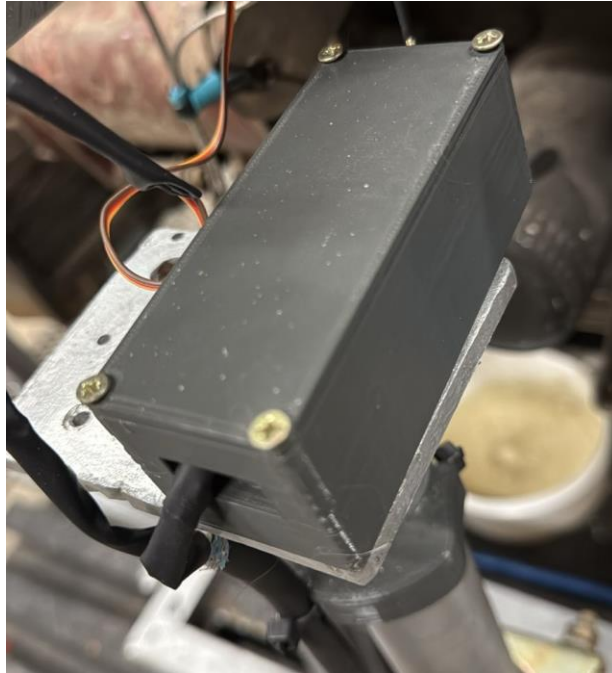
Figura 53. Módulo MAX6675 temperatura de motor instalado.
