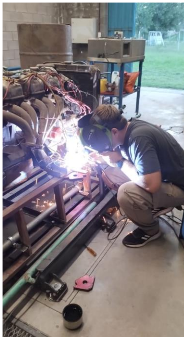
Figura 14. Soldado de los perfiles angulares.
