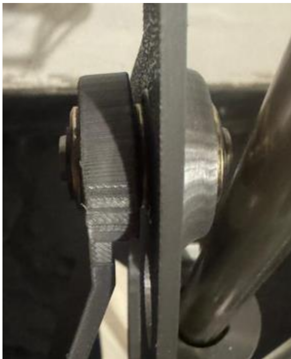
Figura N° 20. Detalle de las articulaciones en las planchuelas
