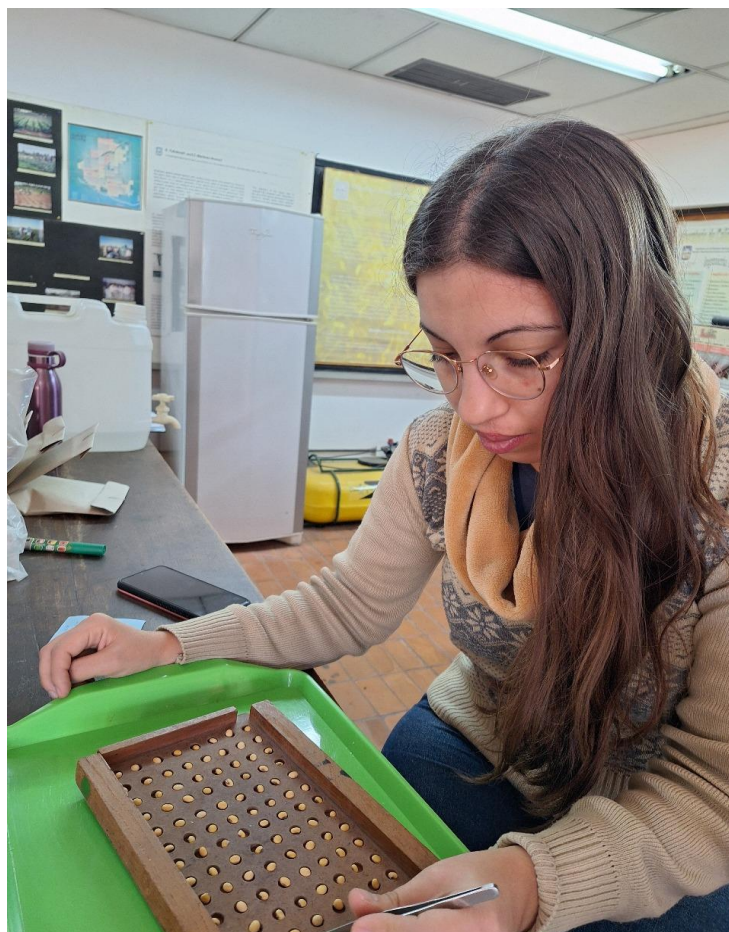
Figura 8: Determinación del peso de 100 semillas. Laboratorio de semillas y granos de la UNSL.
