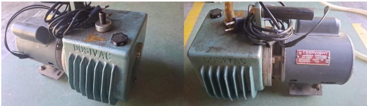
Figura 11. Fotografía de la bomba de vacío a utilizar en el banco de ensayos.
