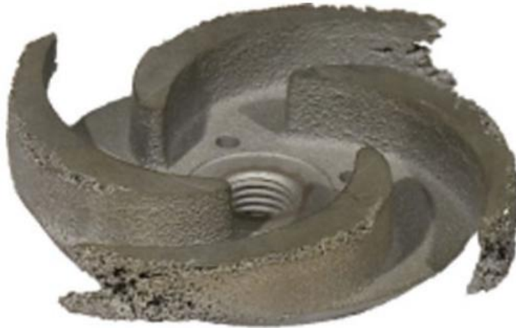
Figura 5. Rodete de una bomba bajo los efectos de la cavitación [7].
