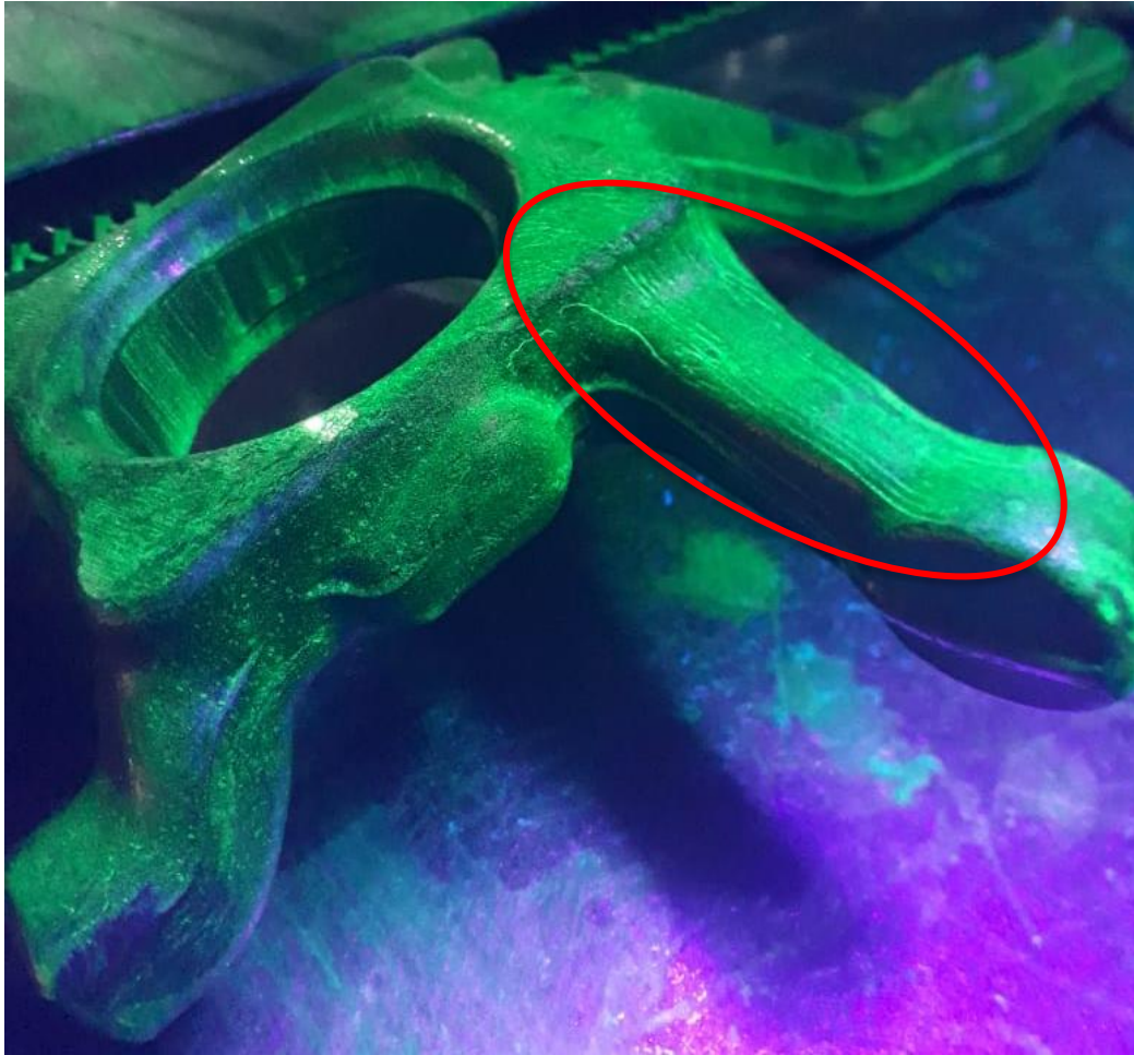
Ilustración 94: Pliegue (solapamiento de material) detectado en control por partículas magnetizables. Esta pieza está en condición "NO OK". Fuente: elaboración propia.
