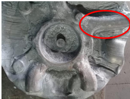
Ilustración 92: Marcas de desgaste en secuencia de preformado de pieza 2525. Fuente: elaboración propia.
