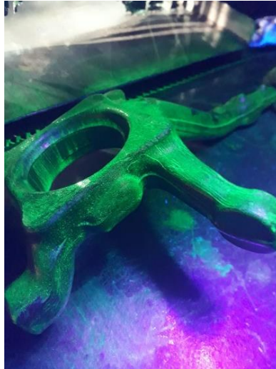
Ilustración 50: Pieza en proceso de inspección por partículas magnetizables. Fuente: elaboración propia.
