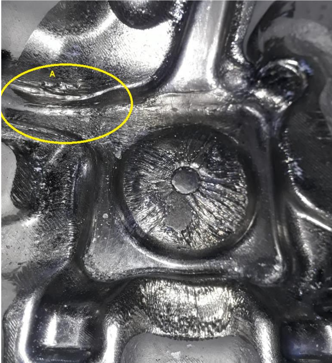
Ilustración 87: Desgaste real de una matriz inferior de preformado. Fuente: elaboración propia.
