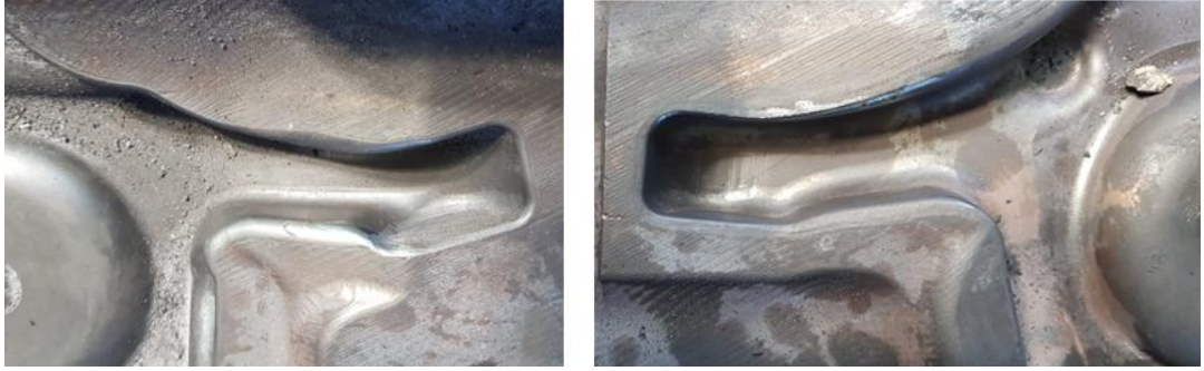
Ilustración 101: Mecanizado final en zona de aporte con electrodo Stellite 21. Matriz inferior (izq.) y matriz superior (der.). Fuente: elaboración propia.
