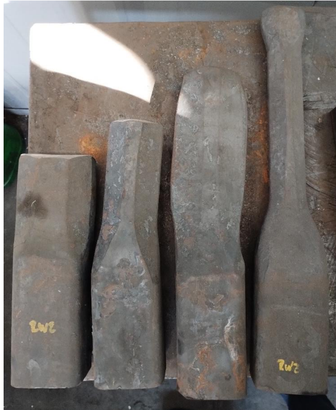
Ilustración 77: Secuencia real obtenido por rolado 1er a 4to paso (de izq. a der.). Fuente: elaboración propia.
