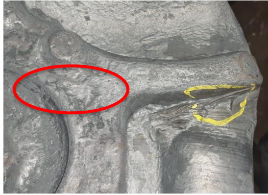
Ilustración 91: Marcas de desgaste en secuencia de preformado de pieza 2525. Fuente: elaboración propia.
