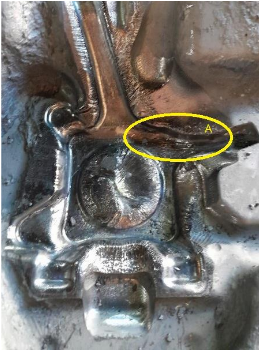
Ilustración 90: Desgaste real de matriz superior de preformado. Fuente: elaboración propia.
