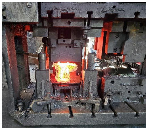
Ilustración 45: etapa de rebabado-punzonado en prensa auxiliar. Fuente: elaboración propia.
