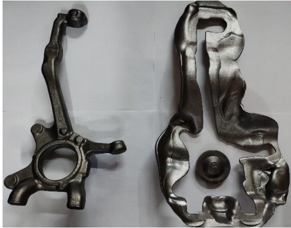
Ilustración 46: Pieza rebabada y punzonada (derecha). Descartes de rebaba y punzón. Fuente: elaboración propia.
