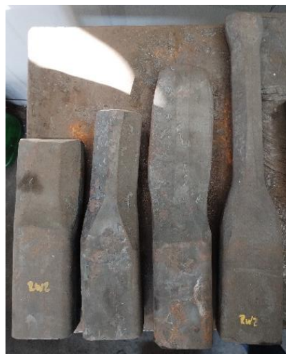
Ilustración 39: Secuencia de rolado 1er a 4to paso. Fuente: elaboración propia.
