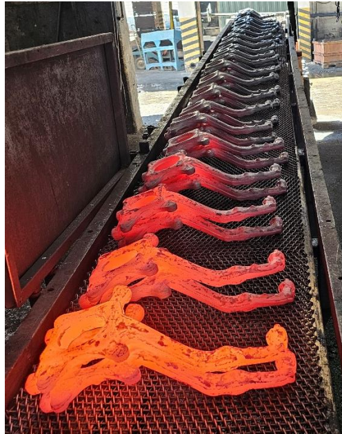
Ilustración 48: Cinta de enfriamiento al aire calmo. Fuente: elaboración propia.
