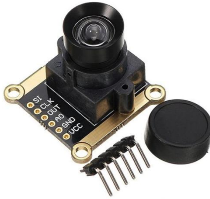
Figura N° 14. Módulo de desarrollo basado en el sensor TSL1401
