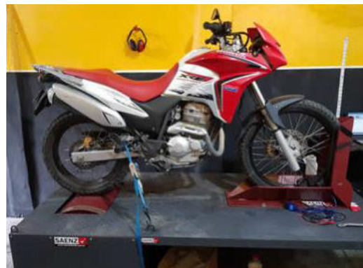
Imagen 77: Motocicleta montada en banco de rodillo inercial
