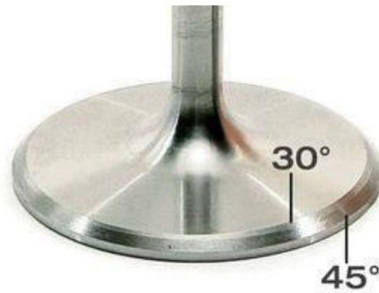
Imagen 45: Ángulos de la válvula de escape
