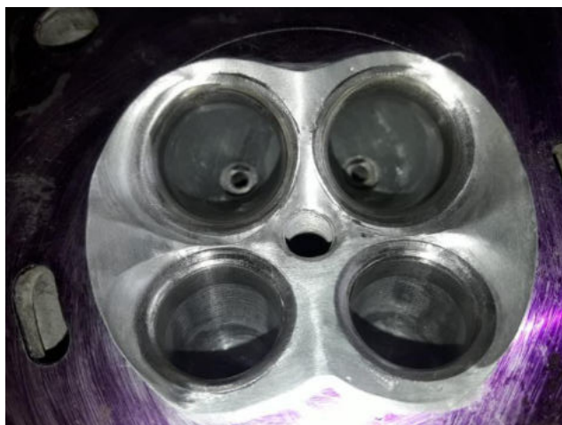
Imagen 16: Retrabajo de la cámara de combustión
