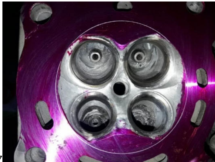
Imagen 15: Retrabajo de la cámara de combustión
