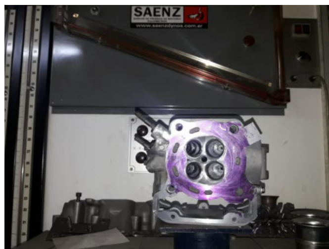
Imagen 17: Retrabajo de la cámara de combustión finalizada
