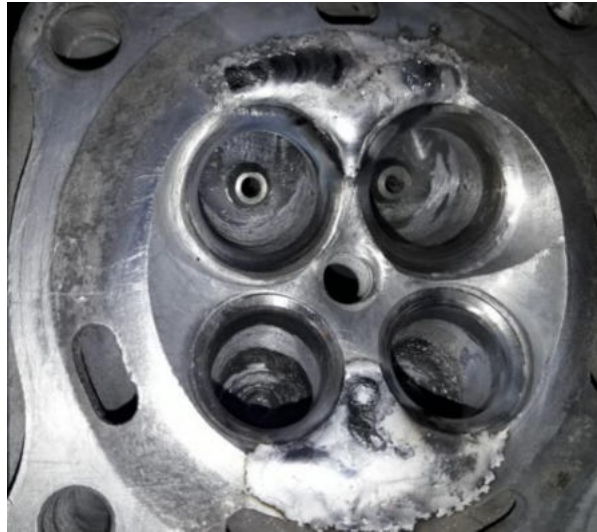
Imagen 14: Retrabajo de la cámara de combustión
