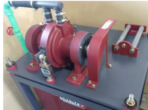
Imagen 75: Banco de prueba de freno dinamométrico hidráulico
