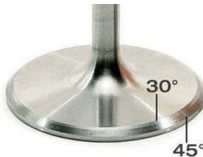
Imagen 29: Ángulos de la válvula de admisión
