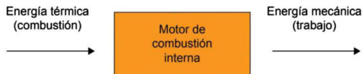
Imagen 1: Proceso de conversión de la energía térmica en mecánica
