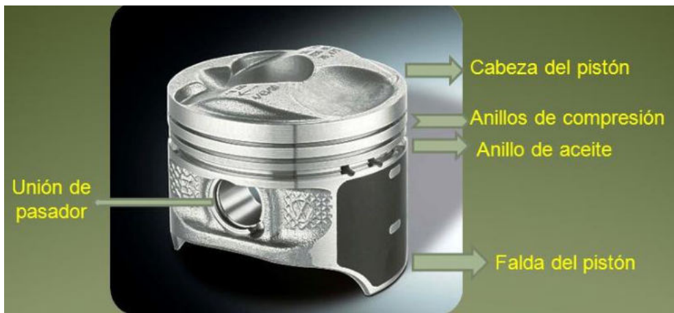
Imagen 4: Partes de un pistón
