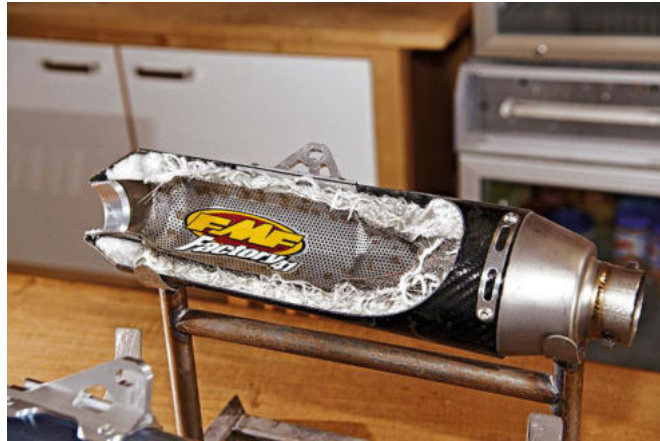
Imagen 51: Composición del silenciador de escape
