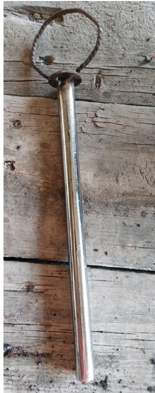
Figura 13: Tipo de uniones utilizadas para fácil armado.
