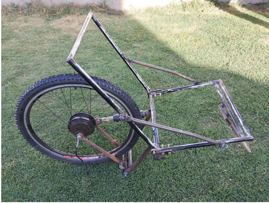
Figura 14: Silla Monorrueda asentada sobre su propio caballete (Descanso seguro con usuario montado).
