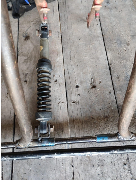
Figura 12: Vista superior de la horquilla incluida ya en la estructura.
