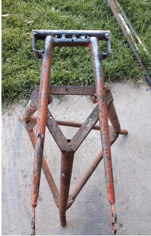
Figura 10:Parte de la horquilla soldada.
