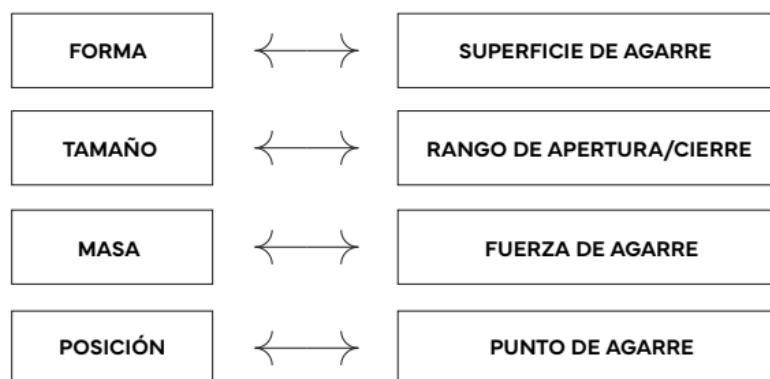
Figura N°3. Esquema de relación entre las características de la probeta y las especificaciones del sistema de manipulación.
