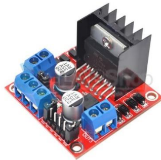
Figura N° 11: Puente H – L298n
