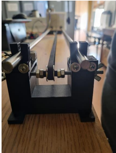
Figura N° 78: Foto de soporte de varillas conducido
