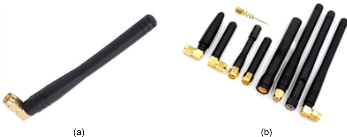
Figura N° 28: Antena monopolo omnidireccional con conector SMA macho usada en los transceptores. (a) Antena de 915 MHz. (b) Antenas de distintas frecuencias del mismo fabricante y helicoide interno. Fuente: [22].
