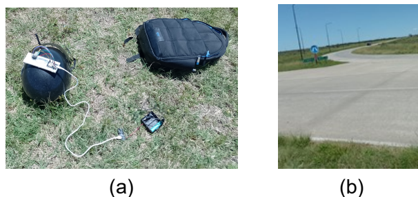
Figura N° 43: Prueba de distancia del módulo LoRa. (a) El módulo 1 se colocó en la rotonda de la RP 55. (b) Rotonda de la RP 55, próxima al peaje de Villa Mercedes.
