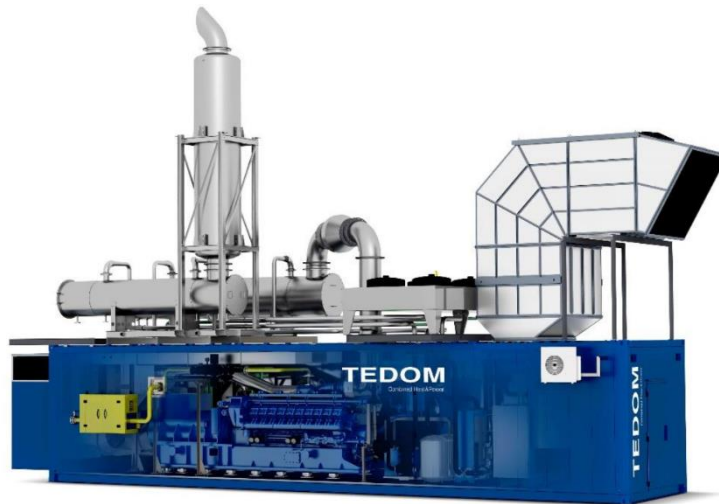
Figura N°20: Central de cogeneración de 1MW de potencia eléctrica, con recuperación de calor de sistema de refrigeración.
