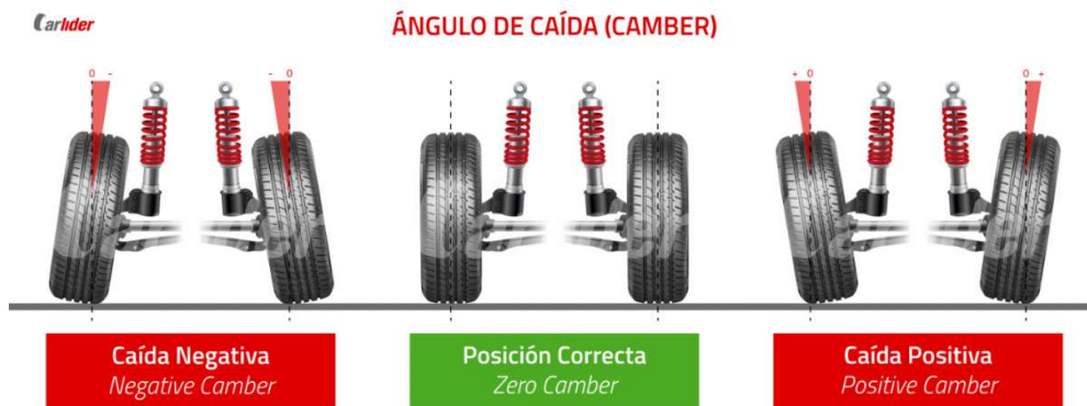
Imagen 29 - Ángulo de caída en neumáticos.
