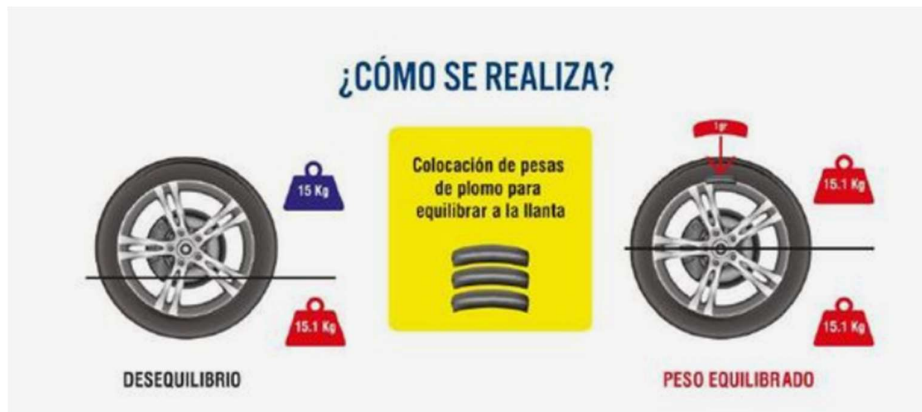
Imagen 24 - Descripción gráfica del efecto del balanceo sobre el conjunto neumático-llanta.
