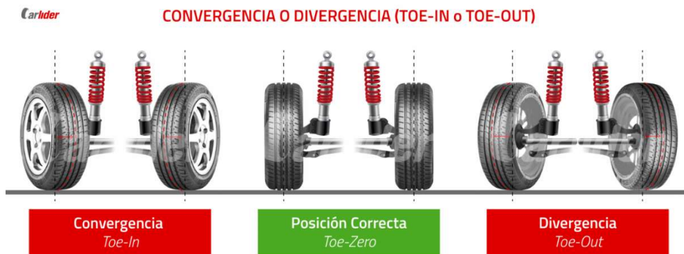
Imagen 28 - Ángulos de corrección TOE-IN y TOE-OUT.
