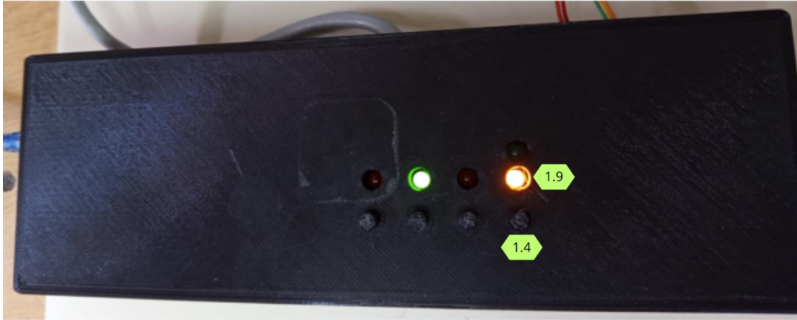
Figura N°95 Botón Sub-Modos (1.4) y Led Sub-Modo Trayectoria (1.9)
