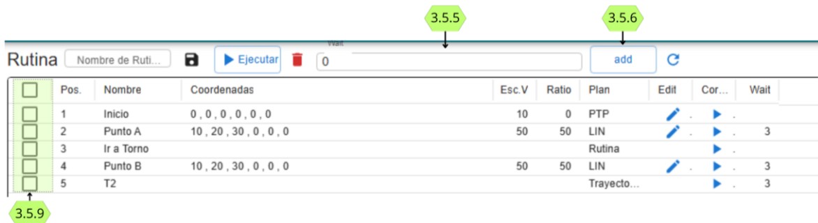
Figura N°48 Botón agregar tiempo de espera (3.5.6), check de instrucciones de rutina (3.5.9) e Input tiempo de espera (3.5.5).
