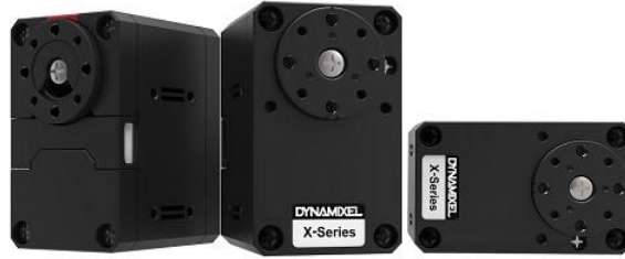
Figura N°4 Motor Dynamixel XL430-W250.
