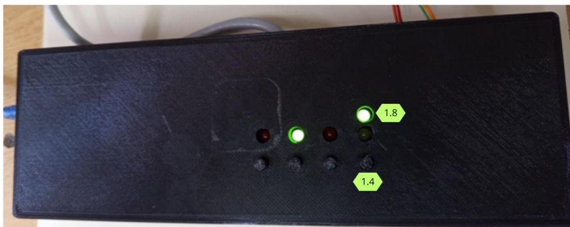
Figura N°94 Botón Sub-Modos (1.4) y Led Sub-Modo Punto (1.8)
