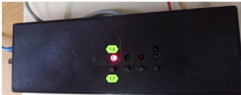
Figura N°89 Botón Modo Control B (1.1) y Led Modo Control (1.5)
