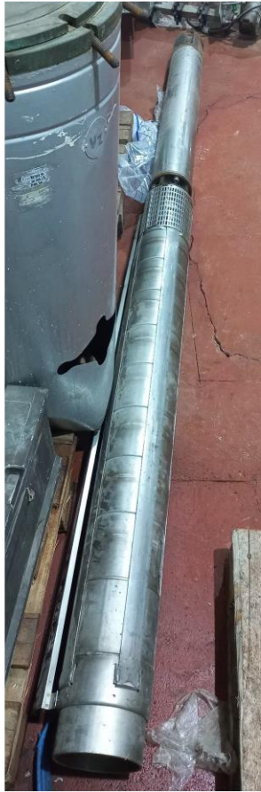
Figura 6. Electrobomba sumergible de pozo
