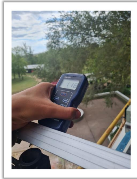
Figura N° 83. Medición de irradiancia para la prueba 1.
