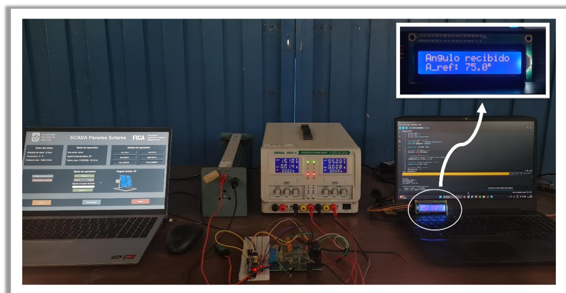
Figura N° 101. Envío de ángulo de referencia de 75 ° a través del sistema SCADA.
