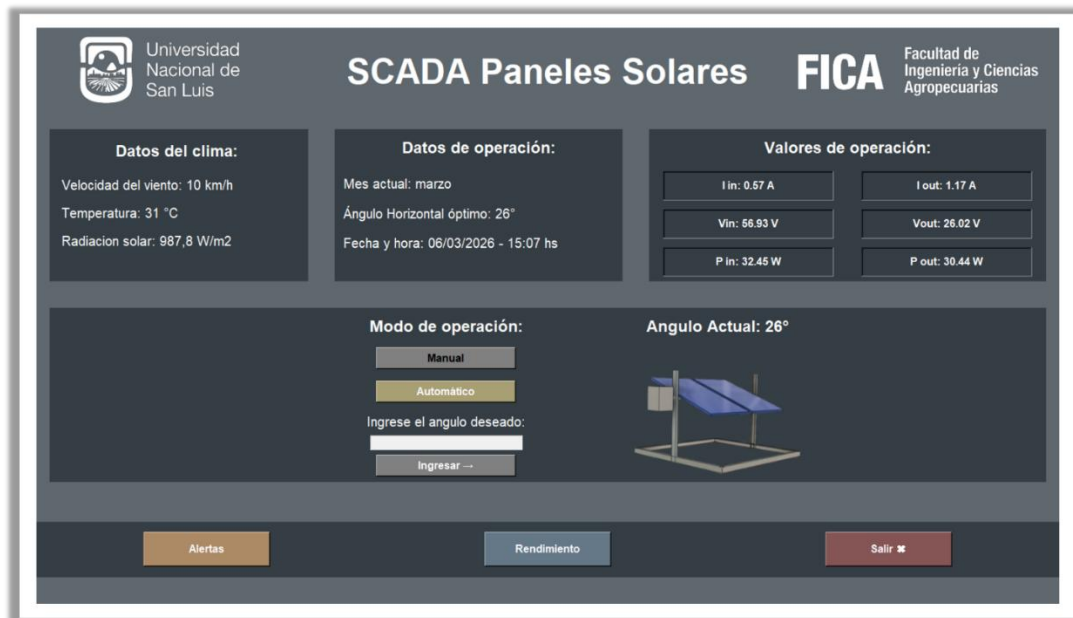
Figura N° 97. Visualización de las variables al conectar la carga en el sistema SCADA
