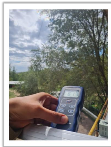
Figura N° 82. Medición de irradiancia para la prueba 2.
