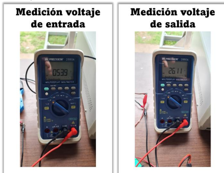
Figura N° 98. Medición de voltajes de entrada y salida con carga.
