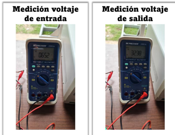
Figura N° 96. Medición de voltajes de entrada y salida sin carga.
