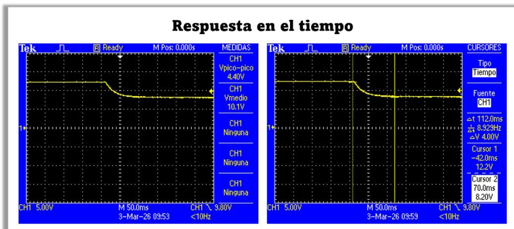
Figura N° 75. Respuesta en el tiempo del voltaje ante cambio de referencia de 12 [V] a 8 [V].
