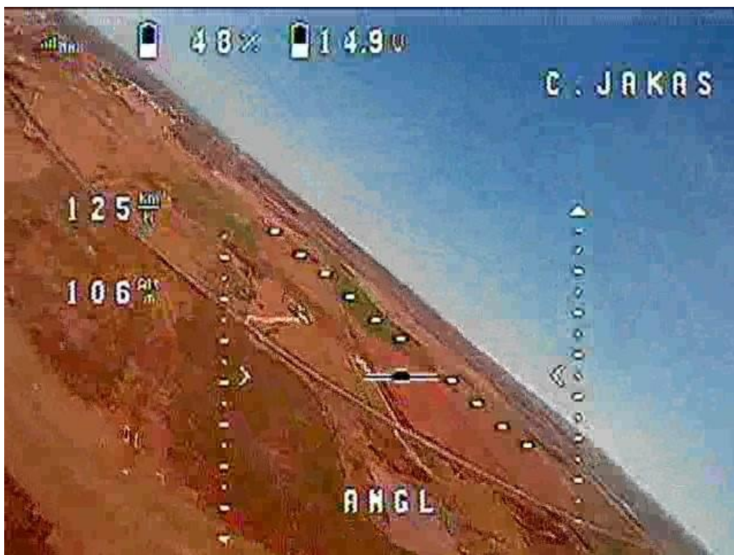
Figura 46. Captura de la cámara FPV con el modo ANGLE activado.
