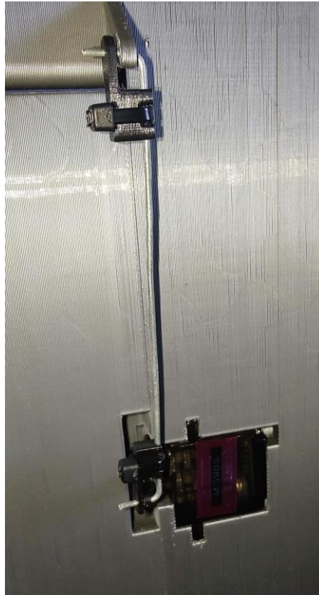
Figura 29. Montaje y unión del servomotor y alerón.
