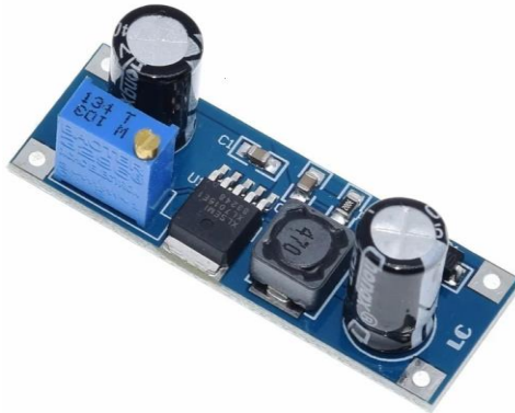
Figura 16. Regulador de voltaje XL7015.
