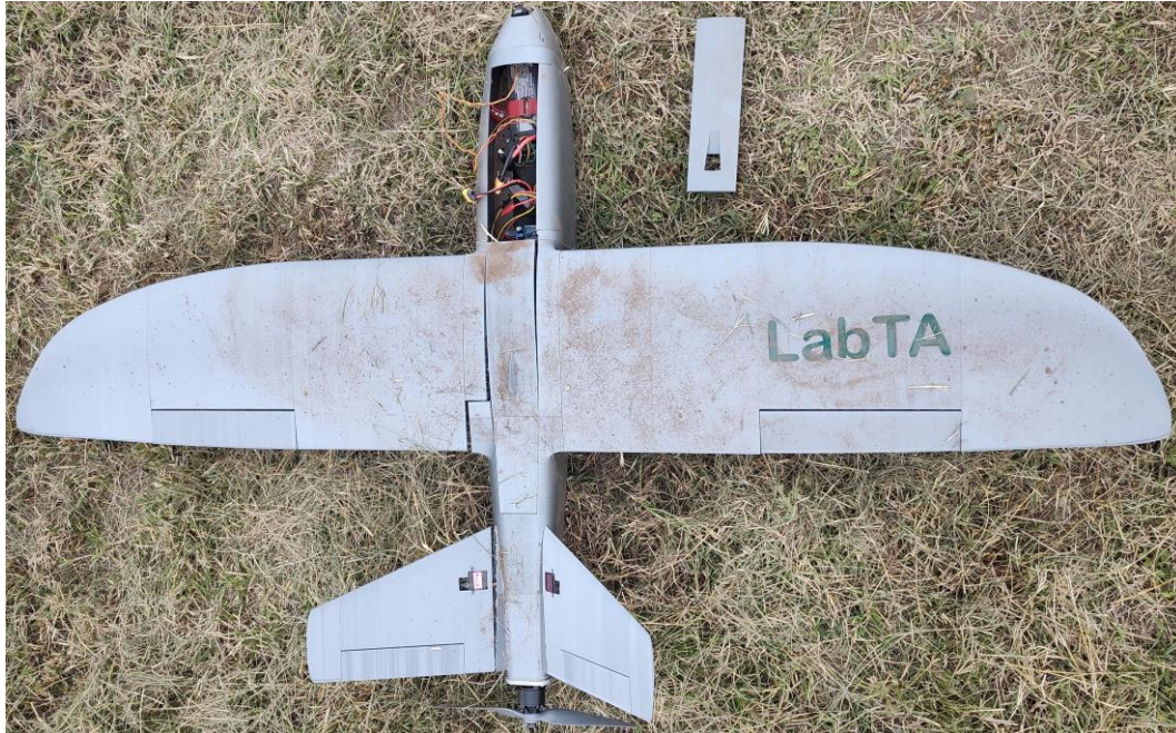
Figura 38. Daños en el fuselaje y tapa superior luego del aterrizaje del primer vuelo.
