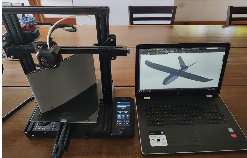
Figura 20. Ender 3 V2 imprimiendo una pieza.
