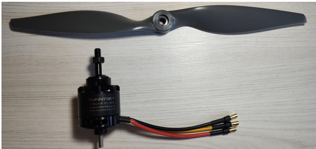
Figura 36. Motor brushless SunnySky X2814 y hélice 11x7 pulgadas.
