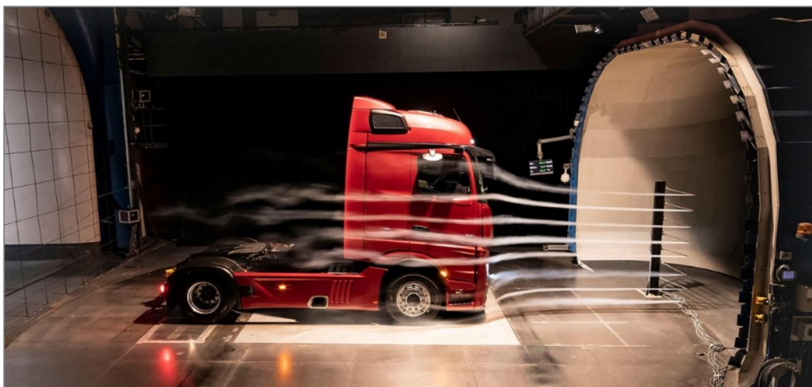
Figura 6. Estudio de aerodinámica de un vehículo de la empresa Mercedes-Benz en el túnel de viento de Daimler AG, ubicado en la sede de Stuttgart-Untertürkheim, Alemania. Extraído de: https://roadstars.mercedes-benz-trucks.com/es_ES/magazine/2021/february/the-art-of-the-mercedes-benz-developers-is-demonstrated-in-the-wind-tunnel.html
