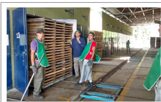
Figura 30. Zona de egreso de carros con producto seco. Extraído del trabajo de tesis "Deshidratado de ciruelas D'Agen en túneles de configuraciones inversas" de la Dr. Delia Paola Urfalino [1].
