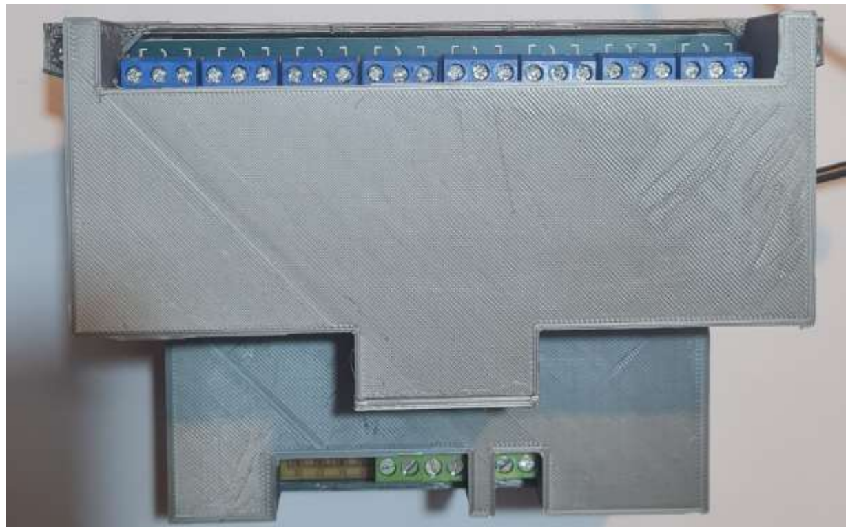
Figura N° 76: Ensamblaje PLC - Vista trasera
