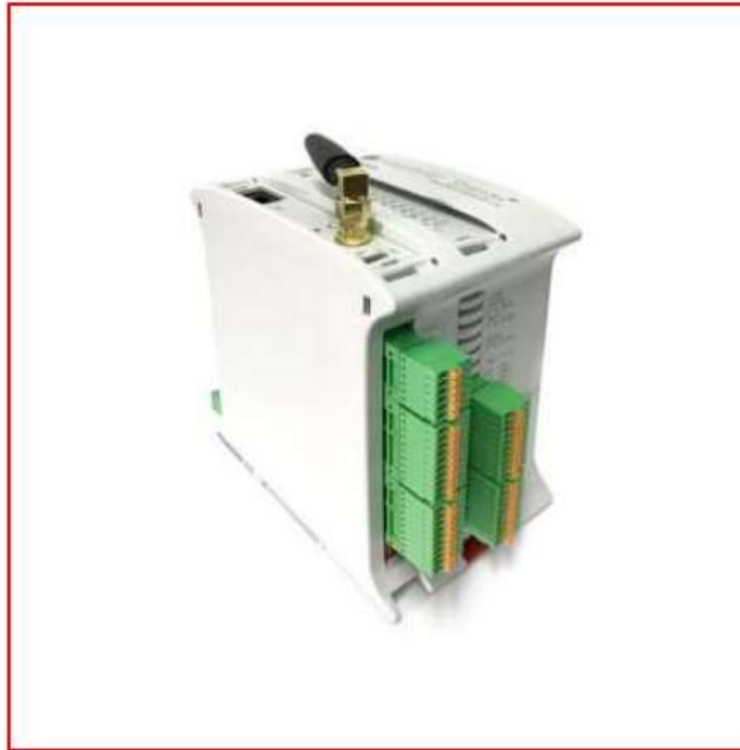
Figura N° 43: PLC basado en ESP32 de Industrial Shields
