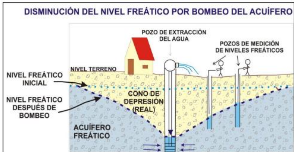
Figura 5. Funcionamiento de un acuífero freático durante el bombeo. Fuente: [12].
