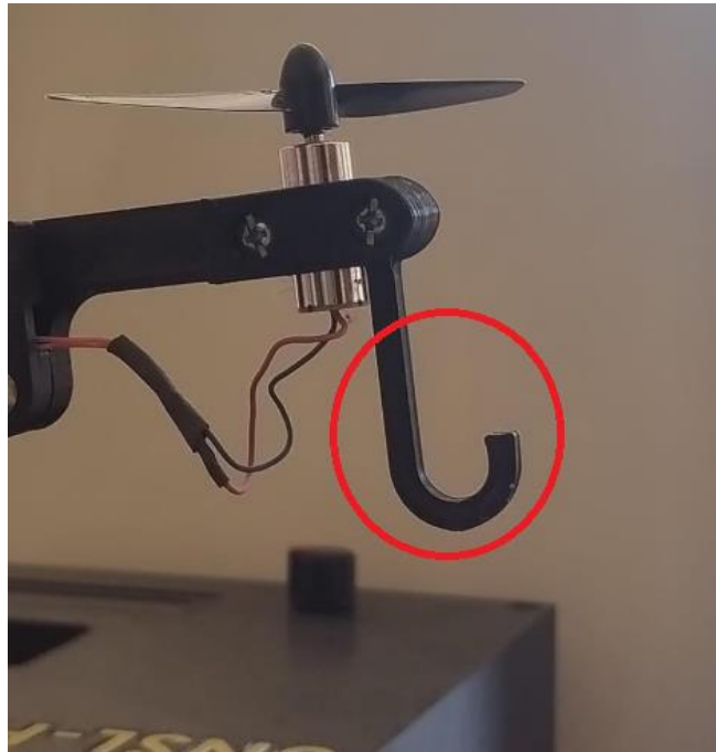
Figura 24. Estructura de soporte preparada para la aplicación de perturbaciones impulsivas.
