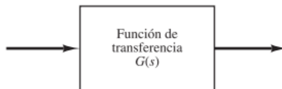
Figura 1. Elementos de un diagrama de bloques Fuente: tomada de [4]
