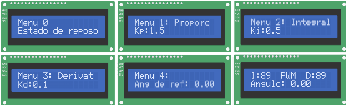
Figura 27. Secuencia de visualización del menú en la pantalla LCD.
