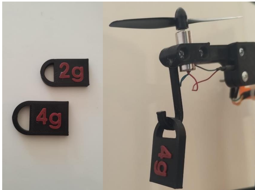
Figura 25. Masas de perturbación y su aplicación en el dispositivo.
